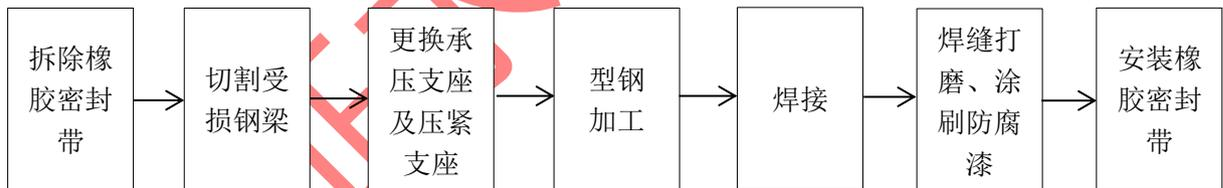
图 6.3.1 中钢梁维修工艺流程图
